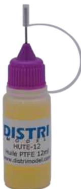
Huile au PTFE (polytétrafluoroéthylène) micronisée. Flacon souple avec canule métallique permettant de déposer l'huile au goutte à goutte, même dans les endroits les plus inaccessibles. Particulièrement adaptée à la lubrification des pointes d'essieux dans les bogies en plastique moulé ou dans les inserts laiton ou dans les pignonniers nylon, Delrin™ ou métallique des bogies moteur. Conditionnement : 12 ml
