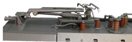
Les Prima 3U du constructeur ferroviaire Alstom sont des locomotives tricourant pouvant circuler sous caténaires 1,5 kV continu, 25 kV 50 Hz et 15 kV 16,7 Hz (Allemagne ou Suisse).
