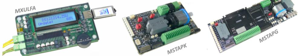
Le module de mise à jour de décodeurs et de téléchargement du son MXULF charge le nouveau logiciel ou le projet sonore à partir de la clé USB ou de l'ordinateur, via le rail ou pour le son, via l'interface SUSI (particulièrement rapide).
